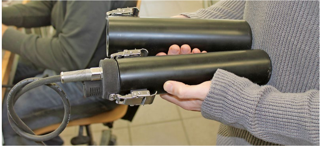
Der Leuchtmitelesatz dieser Taucherlampe wäre in Spritzguss kaum – und nur mit einem sehr teuren Werkzeug – herstellbar gewesen. 3D-Druck mit Sintertechnik macht eine sehr kompakte Lösung möglich, die heute in Stückzahlen von einigen Hundert pro Jahr produziert wird. Foto: K-ZEITUNG / Albus
